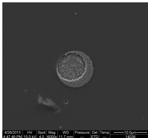
图六 炉渣 14036 内铁颗粒二次电子像
